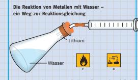
Bei der Reaktion von Alkalimetallen und Erdalkalimetallen mit Wasser setzen die Metall-Atome Wasserstoff frei. Das Verhältnis  $n$  (Metall-Atome) :  $n$  (H-Atome) kann in einem Versuch bestimmt werden. Hierzu wird ein Metallstück abgewogen und so in ein Gefäß mit Wasser gelegt, dass es nicht mit Wasser in Berührung kommt. Dann verschließt man das Gefäß und lässt das Metallstück ins Wasser gleiten. Das Volumen des entstehenden Wasserstoff wird gemessen.
